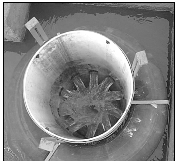
FIGURA 2. Regulador automático de vazão: (a) esquema em corte e (b) escoamento pelos orifícios.
