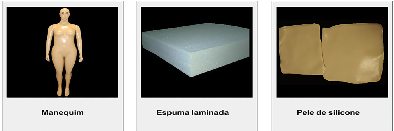
Figura 1. Materiais utilizados para construção de simulador para aplicação de insulina. Ribeirão Preto, 2017. Fonte: Arquivo do pesquisador.
