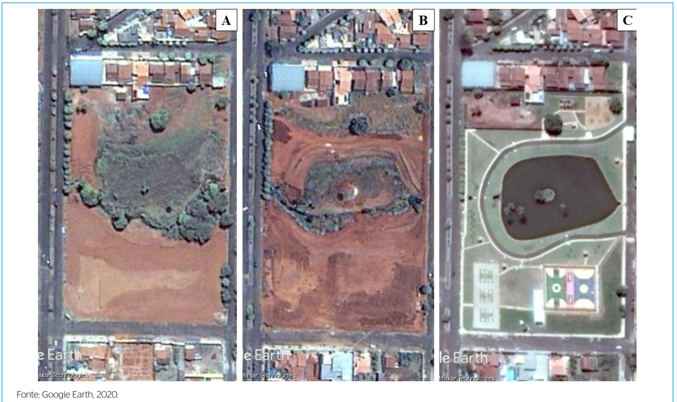
Figura 4 - (A) Local de construção de R3, com retirada da vegetação no ano de 2011; (B) processo de escavação na área de vereda para estruturação do lago no ano de 2012; (C) reservatório 3, finalizado em 2013.
