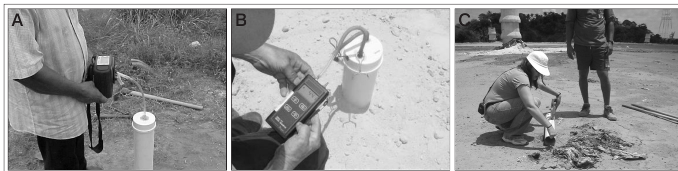
Figura 2 – Instalação e leitura da concentração dos gases e pressão no contato solo-resíduo e medição da espessura da camada. A) Leitura da concentração dos gases; B) leitura da pressão; C) medição da espessura da camada
