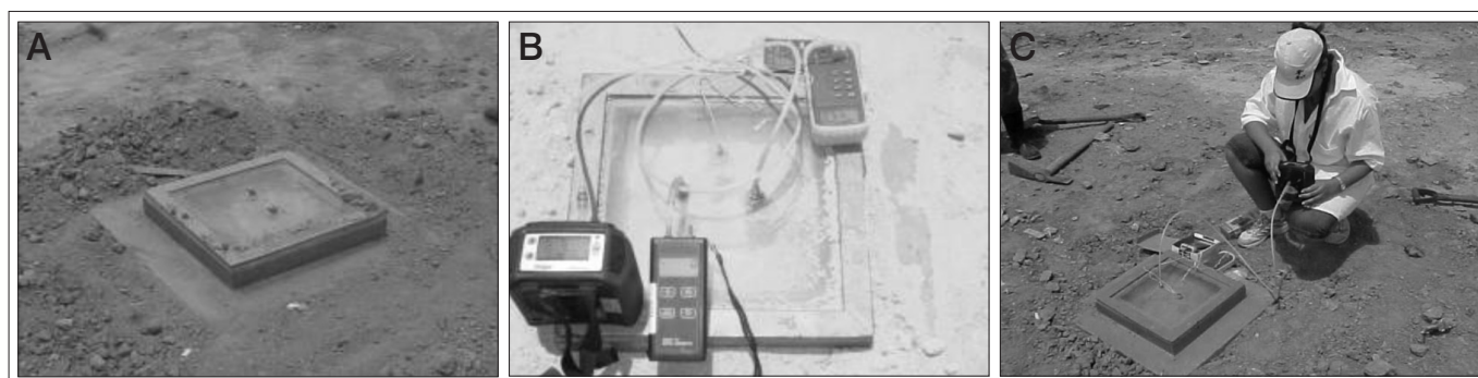
Figura 1 – Instalação e leitura do ensaio de placa de fluxo. A) Cobertura da placa; B) equipamentos utilizados; C) leitura da concentração dos gases
