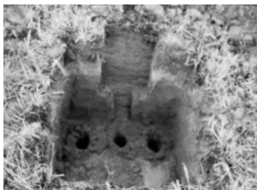
Figura 4 - Detalhe de uma trincheira com amostras já coletadas para análises químicas do solo, nas diferentes profundidades
