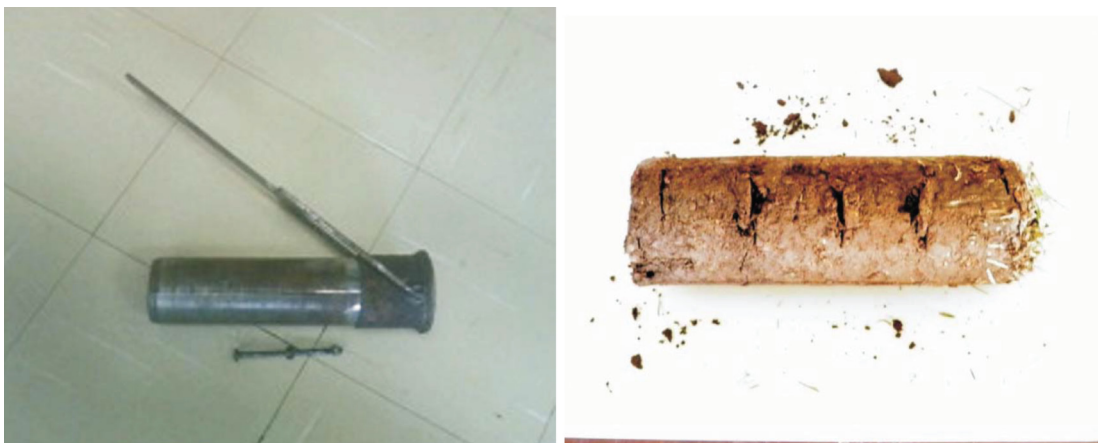
Figura 3. Trado adaptado para amostragem de solo com raízes e uma amostra obtida pelo instrumento. Fonte: Volk et al. (2011).
