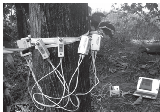
Figura 1. Tomógrafo de impulso instalado no tronco de árvore de teca observando-se o momento das batidas para aquisição dos dados.
