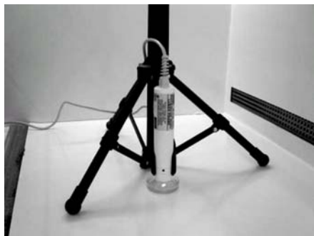
Figura 1 Ilustração do uso da radiação laser sobre a placa de Petri cultivada com bactérias, com área de irradiação predeterminada
