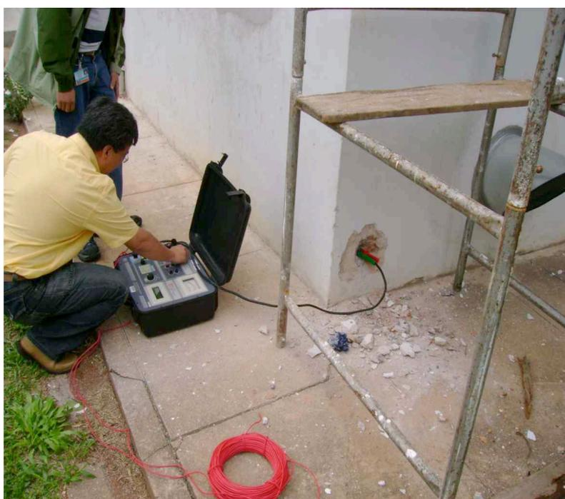
Figura 08 – Técnicos do Instituto de Eletrotécnica e Energia - IEE/USP analisando as possibilidades de implantação de sistema de para-raios através das ferragens do edifício. Fonte: Elaborada pelos autores.
