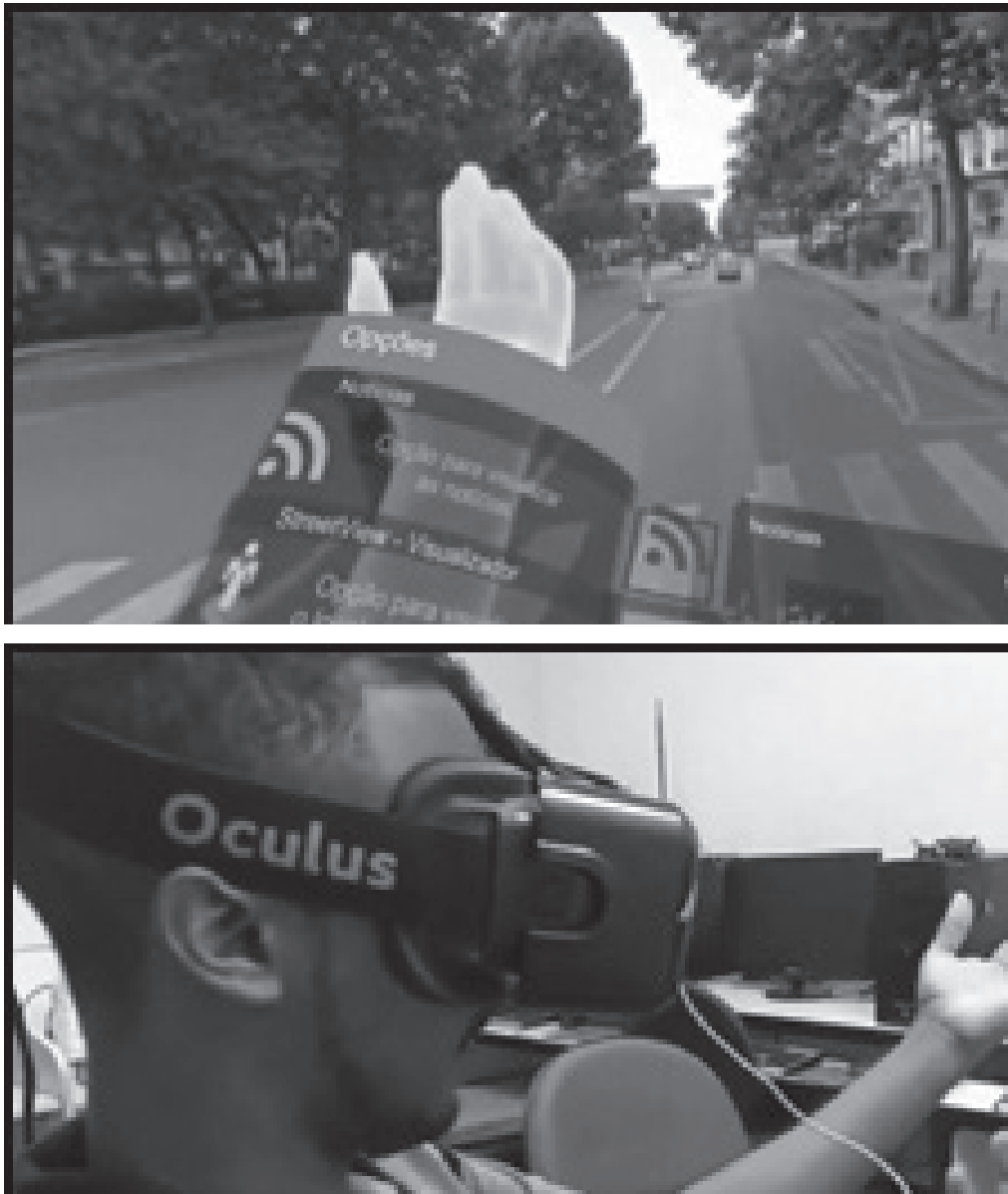
Figura 7 – Detalhe do sensor que lê a posição das mãos do usuário e as representa no ambiente virtual para acionar um dos modelos de interface de controle
