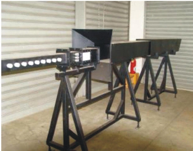
Figura 7: Banco para estudo de instabilidade de combustão.
