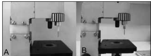
Figura 3 – A: agulha hipodérmica com janela lateral adaptada ao MLCM; B: agulha hipodérmica com êmbolo adaptada ao MLCM MLCM: microscópio de luz convencional modificado.
