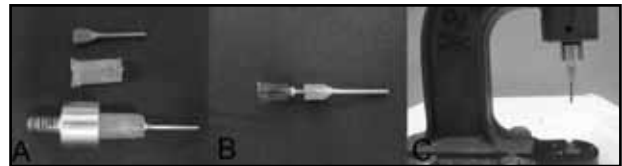
Figura 2 – A: peça metálica feita sob encomenda, agulha hipodérmica modificada, invólucro plástico modificado das agulhas; B: agulha hipodérmica com êmbolo; C: conjunto peça metálica-agulha acoplado à prensa
