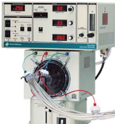
Figura 22 - Sensormedics 3100A - Equipamento oscilatório de alta frequência (HFOV). Fabricante: Viasys Respiratorycare Inc. www.sensormedics.com (EUA).
