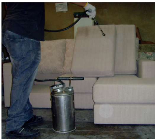
Figura 1 – Sistema de pulverização da resina com compressão manual e válvula de descarga. Note a presença de gotículas na lente da câmera em consequência ao spray do produto.
