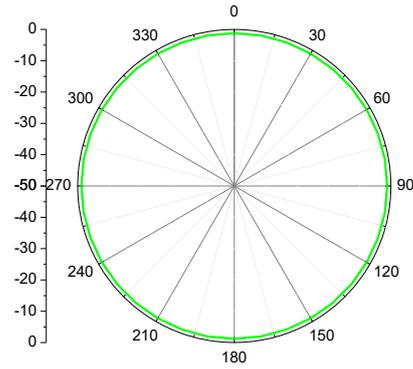
Fig. 10. (b) H-plane radiation pattern
