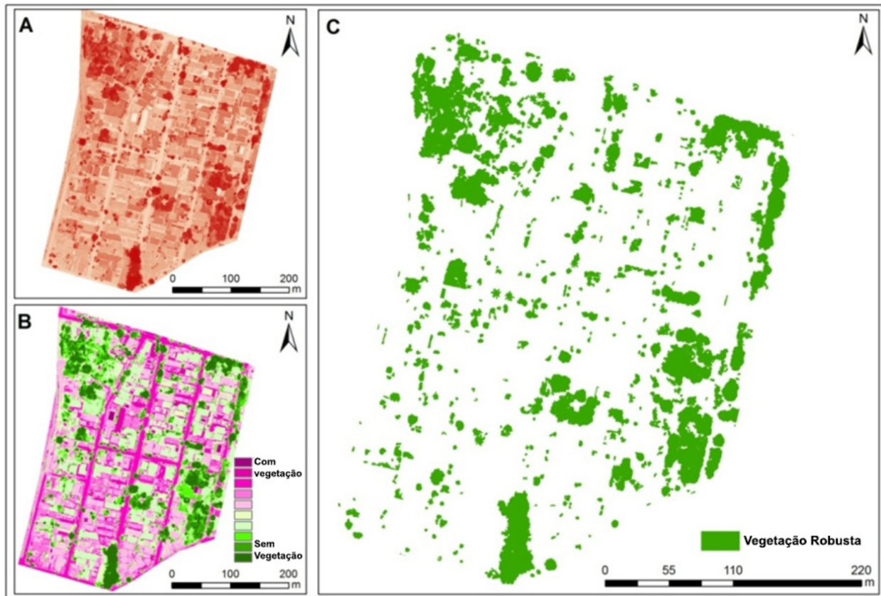
Figura 5 - A) NDVI; B) Fatiamento do NDVI, rosa sem vegetação e verde com vegetação; C) Fragmentos de vegetação robusta.
