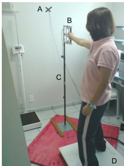
Figura 1. Posicionamento adotado pelo judoca simulando a técnica Jigo-Hon-Tai . A) LED; B) dinamômetro de preensão manual; C) pedestal e D) plataforma estabilométrica.
