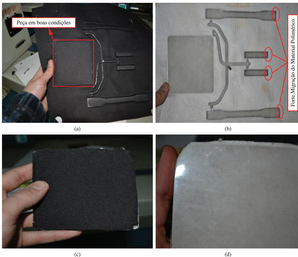
**Figura 4.** a) parte não visível da cavidade quadrada após a retirada do excesso de tecido; b) parte não-visível; c) parte visível da injeção sobre tecido no IFSul; d) parte não-visível. Detalhe na migração do material polimérico através do tecido.
