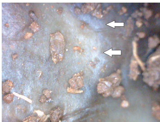
Figura 10. Amostra de filme de amido com 4% de lignossulfonato Vixil S, retirado após a 8ª semana de condicionamento em solo. Ampliação 50X.
