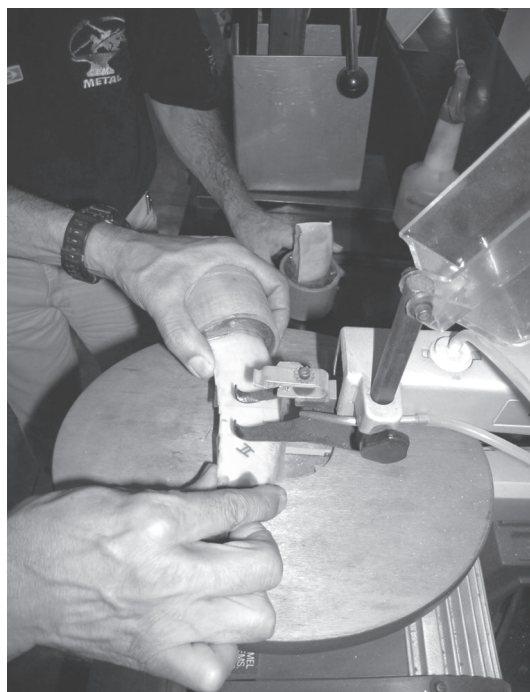
Fig.6. Indução de fratura completa na região central do bico com auxílio de serra de fita.
