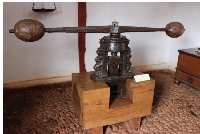
Figura 8. Prensa utilizada na Casa de Intendência e Fundição de Sabará para cunhar o selo da Coroa Portuguesa em barras e lingotes de ouro do Museu do Ouro, Sabará. Foto do autor LEF
