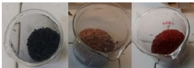
Figura 2. Aspecto de uma amostra de catalisador NiMo/Al 2 O 3 desativado (esquerda) após oxidação do coque a 500 °C (centro) e 600 °C (direita)
