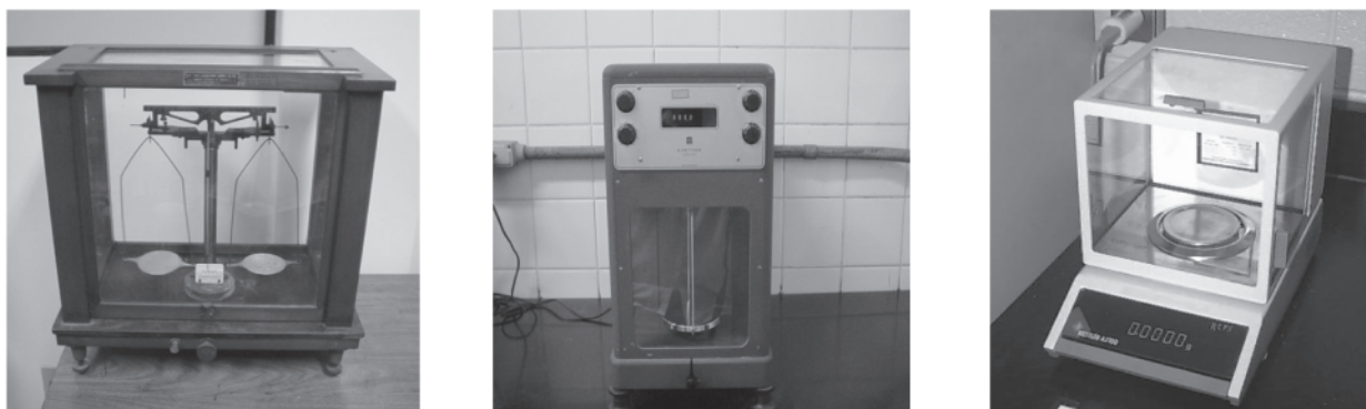
Figura 13. A evolução das balanças analíticas no século XX. À esquerda: balança analítica clássica de dois pratos, origem americana, 1932. Ao centro: balança de um prato, origem suíça, 1960. À direita: balança eletrônica moderna, origem suíça, 2000. Acervo do Museu da Química Prof. Athos da Silveira Ramos
