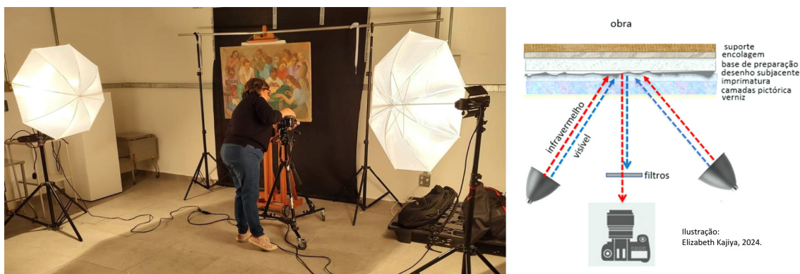
Figura 5. À esquerda, momento da aquisição de imagens no infravermelho (IR), e à direita esquema ilustrativo do arranjo utilizado nas fotografias no infravermelho, indicando a posição do equipamento e a interação da luz com a pintura “Costureiras”, de Tarsila do Amaral, de 1950, o/s/t, com 73,3 × 100,2 cm (fonte: acervo MAC-USP, foto: Elizabeth Kajiya, 2022)
