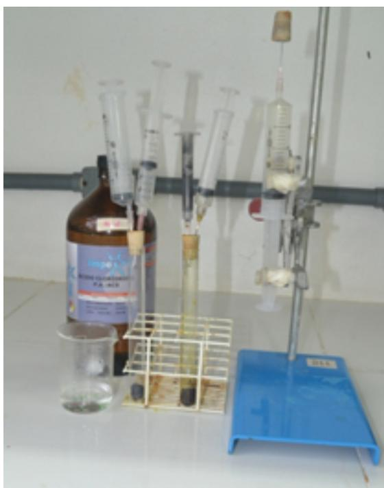
Figura 5. Reator miniaturizado para preparação de gás cloro segundo Obendrauf<sup>36</sup>
