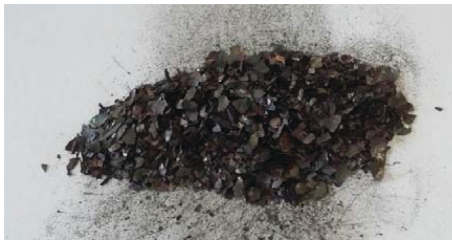
Figura 1. Componentes eletroativos isolados após eliminação do solvente não aquoso e raspagem manual
