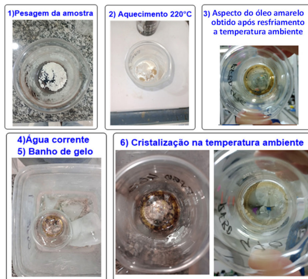
Figura 3. Fotos das etapas da síntese sem solvente do ácido piroglutâmico: o sólido reagente; fusão, resfriamento do óleo, e solidificação induzida do produto. Notar que a manipulação do béquer ocorre após o resfriamento. Não manipular o béquer quente com as mãos
