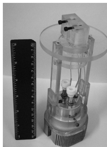
Figura 2. a) Representação esquemática detalhada do calorímetro; b) foto do calorímetro
