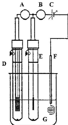
**Figura 6.** Disposição dos componentes para realização do teste de polarização. (A) Medidor de pH. (B) Microamperímetro. (C) Fonte de corrente contínua ajustável. (D) Eletrodo de referência padrão. (E) Eletrodo de referência sob teste. (F) Eletrodo auxiliar de Pt. (G) Solução saturada de cloreto de potássio.
