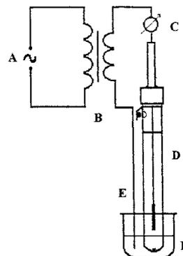
**Figura 2.** Disposição dos componentes para medição de  $R_j$ . (A) Corrente alternada de 110 ou 220 V. (B) Transformador de 110 (ou 220 V) para 5 V. (C) Multímetro medindo corrente em mA. (D) Eletrodo cuja junção está sob teste. (E) Fio de prata. (F) Solução saturada de KCl.
