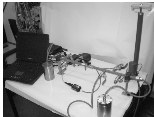
Figura 2. Fotografia mostrando todas as partes que compõem o picnômetro. Câmara V_z (em primeiro plano), câmara V_m , sensor de pressão, bomba de ar comprimido e computador
