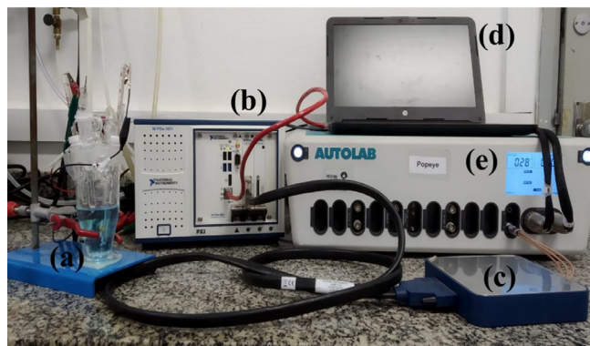
Figura 1. Aparato experimental. (a) célula eletroquímica, (b) controladora NI PXIe-1071, (c) módulo PXIe-6355, (d) computador, (e) potenciostato
