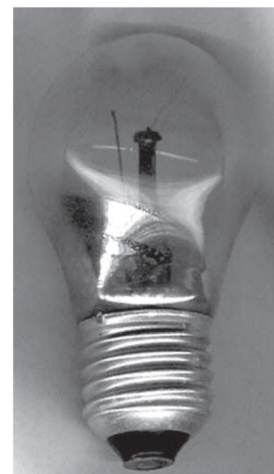
Figura 15. Uma lâmpada incandescente usada como coulômetro de sódio, mostrando a deposição do metal nas paredes da lâmpada após sua difusão através do vidro
