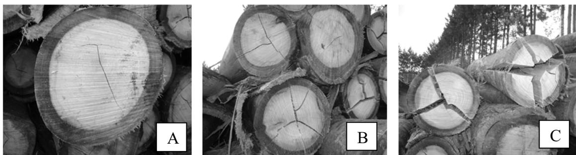
**Figura 1** – Análise visual das rachaduras de topo para determinação do conceito. A: baixo, B: médio e C: alto.
