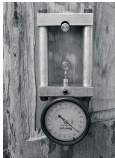
Figura 1 – Equipamento de medição da DRL. Figure 1 – Equipment for LRS measurement.
