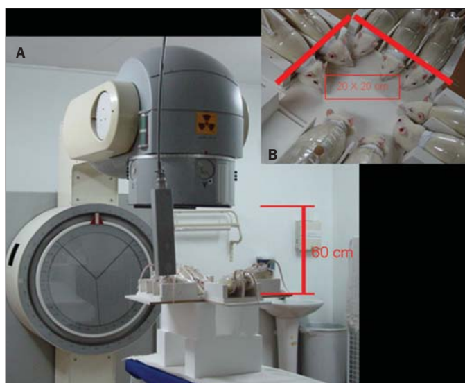
Figura 1. A: Aparelho de radioterapia Philips, modelo XK 5101, estando os animais dispostos sobre este, distando suas cabeças 60 cm da fonte radioativa. B: Animais posicionados sobre um dispositivo de madeira com canaletas, no interior da contenção plástica.
