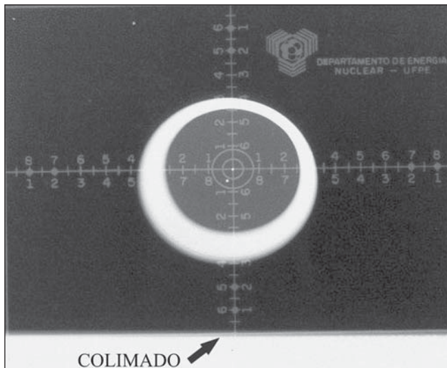
Figura 1. Teste de exatidão do sistema de colimação. Imagem de coincidência de campos em conformidade.
