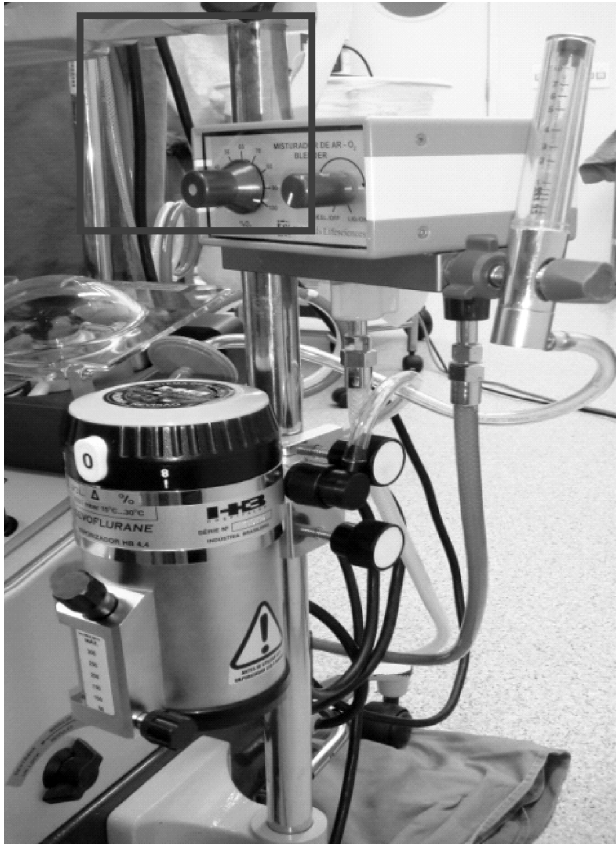
Figura 2 – Misturador de Ar Comprimido e Oxigênio ( Blender ).
