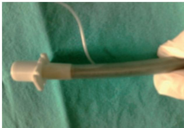
Figura 1. Pared Interna del Tubo - burbujas de aire.
