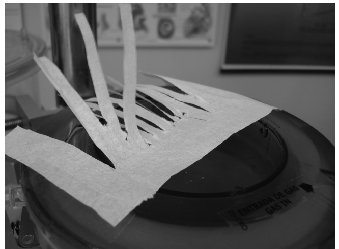
Foto 3 –Movimiento del papel mostrando el escape del oxigenador.
