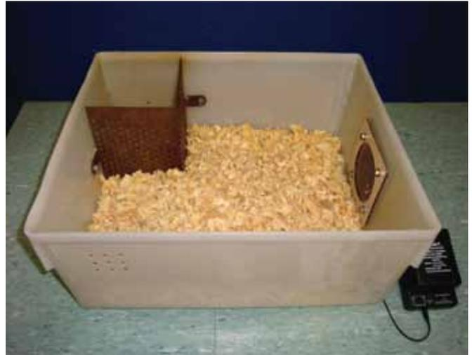
**Figura 1** – Caixa sem a tampa. A divisória de metal isola os ratos do contato físico com o cigarro, permitindo que a fumaça passe livremente para o compartimento maior. Os orifícios permitem circulação do ar ambiente. Exaustor ligado ao transformador elétrico (canto inferior direito).
