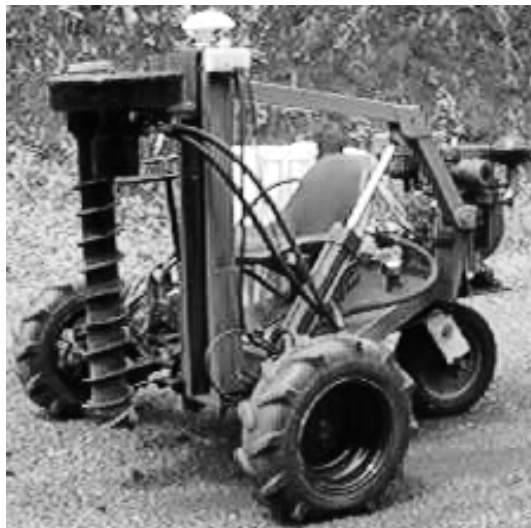
Figura 4. Aspecto final do VAS equipado com antena de GPS.
