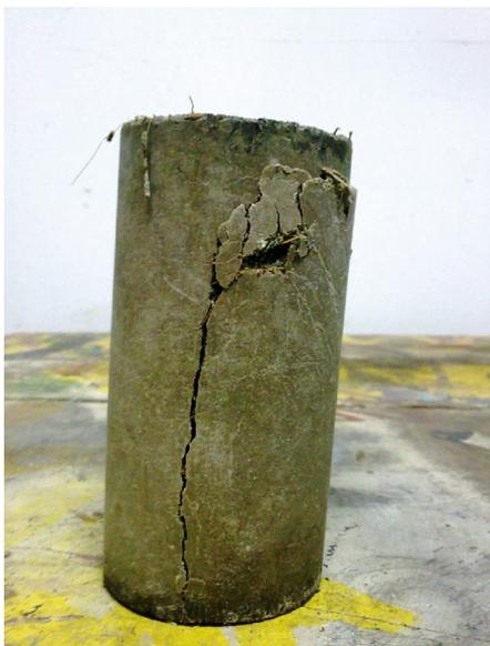
**Figura 4.** Corpo de prova de argamassa FC 25,0 rompido
