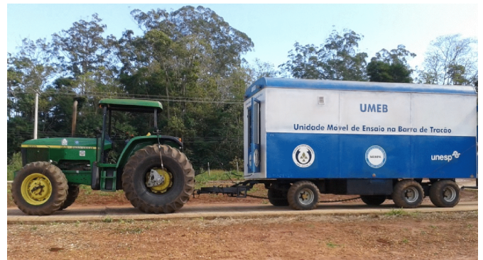
Figura 4. Trator de ensaios instrumentado, acoplado por meio da barra de tração na Unidade Móvel de Ensaio na Barra de Tração (UMEB), sobre a pista de concreto
