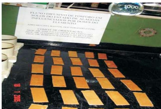
Figura 2. Lâminas de papel de troca aniônica utilizadas no experimento (PA)
