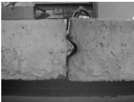
Figura 4. Detalhe dos encaixes entre elementos, sendo preparados para ensaio
