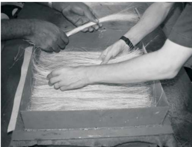
Figura 2. Produção do compósito: (A) lançamento da primeira camada de argamassa no molde metálico; (B) colocação da camada de fibra longa
