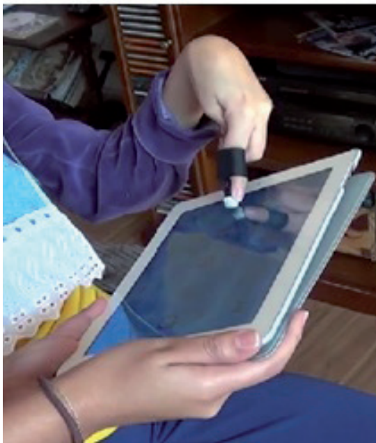
Figura 2. Caneta para tablet adaptada para as condições específicas da participante do estudo elaborada pela pesquisadora principal para a condição experimental B
