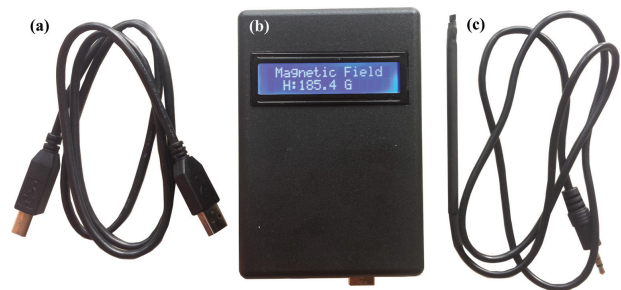
Figura 4: Imagem do gaussímetro montado. (a) cabo USB, em (b) dispositivo montado e, em (c), sonda com sensor Hall na extremidade.
