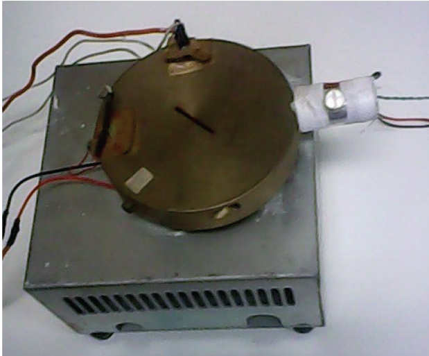
Figura 2 - Visão geral do RTM e do dissipador de calor.
