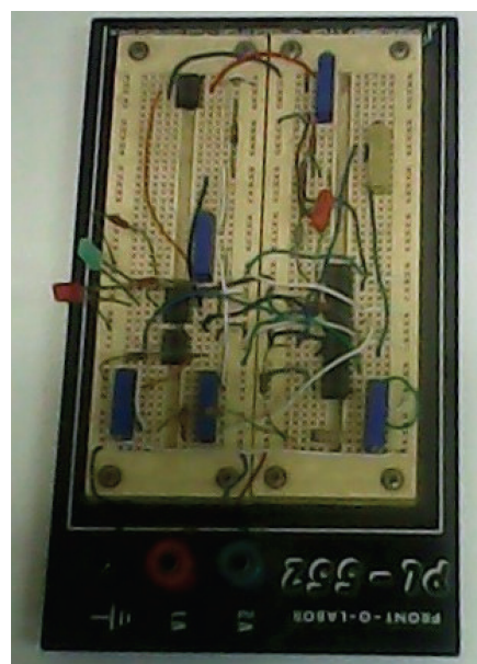
Figura 6 - Vista da montagem do circuito eletrônico de controle montado no protoboard.
