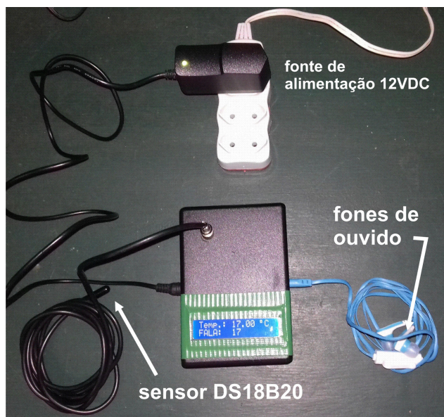
Figura 1: Montagem do circuito do audiotermômetro para testes. Nesta montagem são usados fones de ouvido e uma fonte estabilizada de 12 VDC/1A para alimentação. O sensor de DS18B20 utilizado vem com encapsulamento à prova de água e com cabo de ~1 m de comprimento, facilitando muito a sua utilização nos experimentos. O fone de ouvido pode ser substituído por caixas de som para o caso de trabalhos em grupo.
